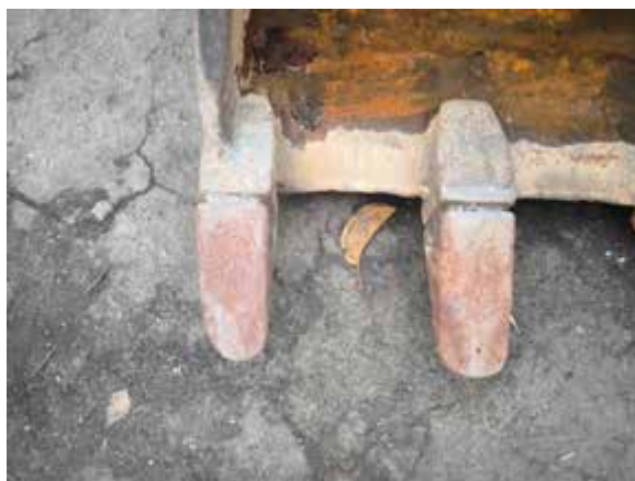
Рис. 3. Корозійні процеси на поверхні елемента A_1 .
