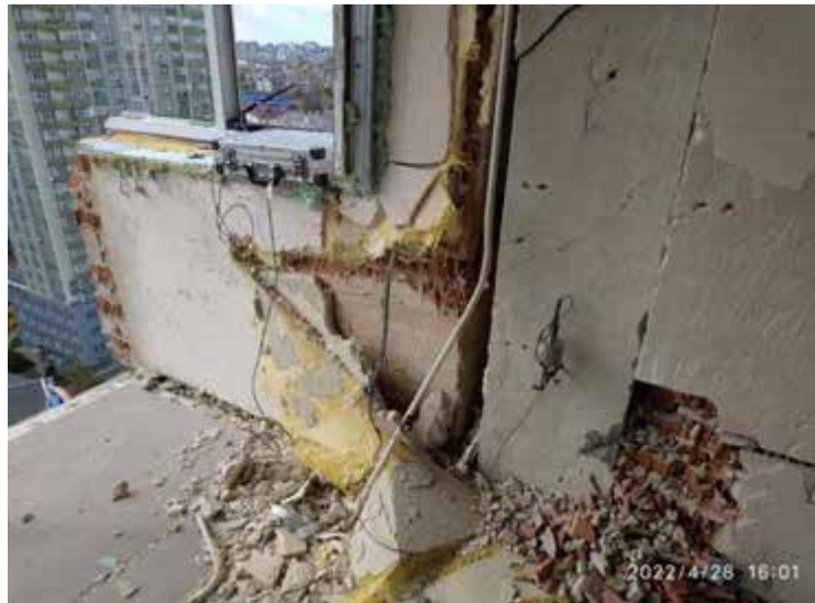
Рисунок 1 – Загальний вигляд вимірювальної апаратури та пілона з закріпленим акселерометром під час проведення вібраційної діагностики пошкодженого пілона (вісь Ж) у квітні 2022 р.
