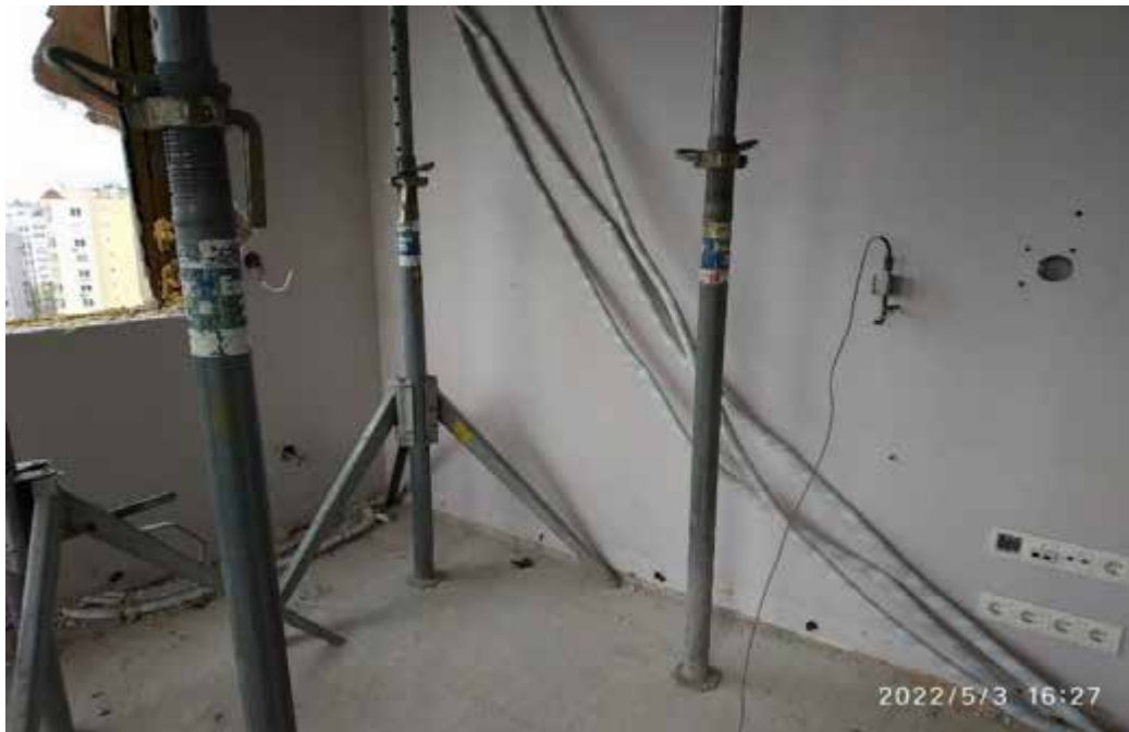
Рисунок 2 – Закріплення акселерометра до монолітної діафрагми на 20 поверсі будинку (вісь 5/И) під час проведення вібраційної діагностики в травні 2022 р.
