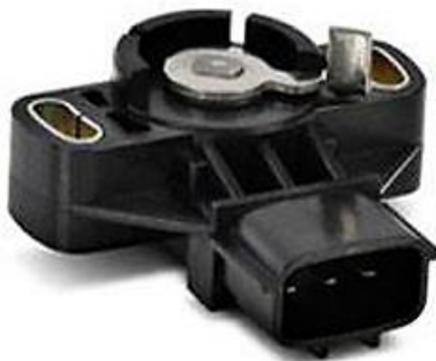
Рис. 2.8. Датчик положення дросельної заслінки ДПДЗ випускаються в двох варіантах:
