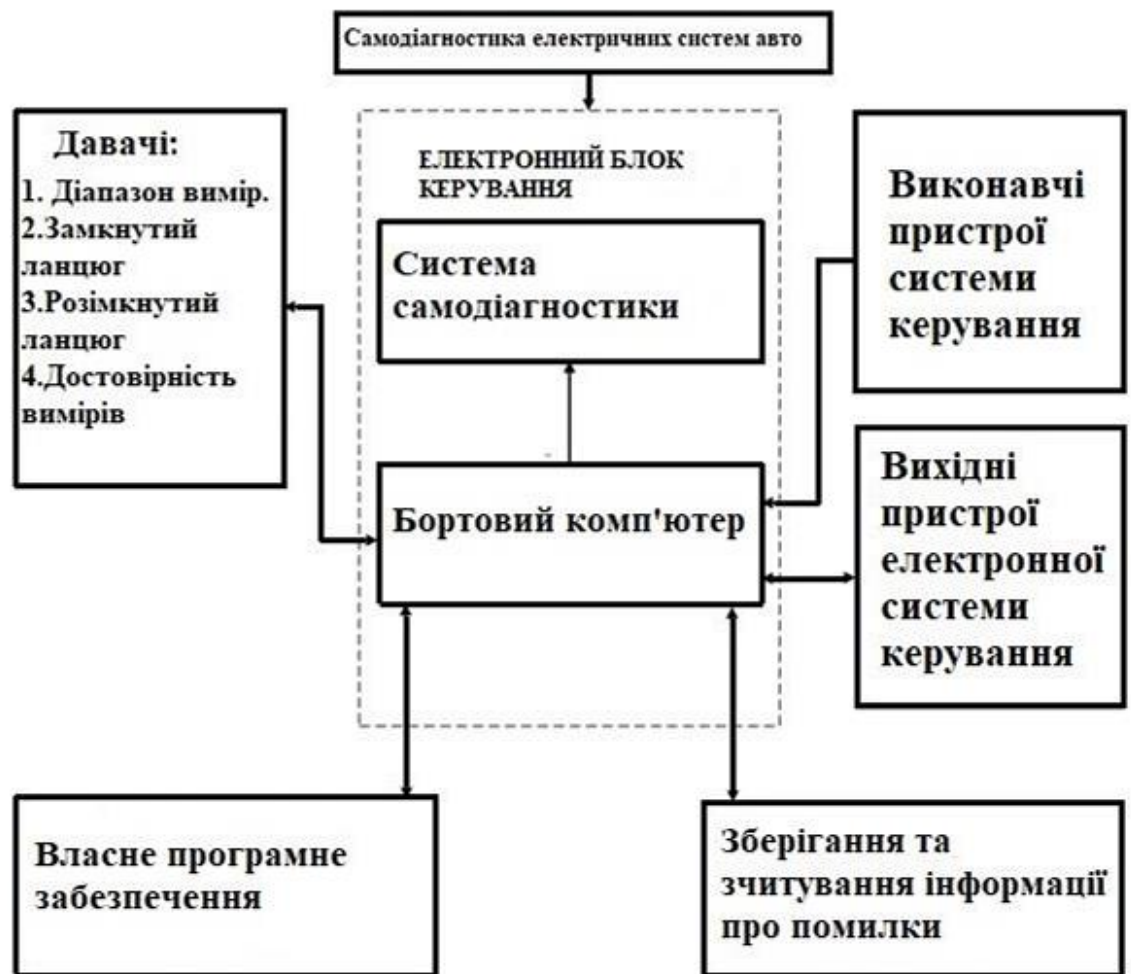
Рис. 2.4. Структурна схема самодіагностики автомобіля
