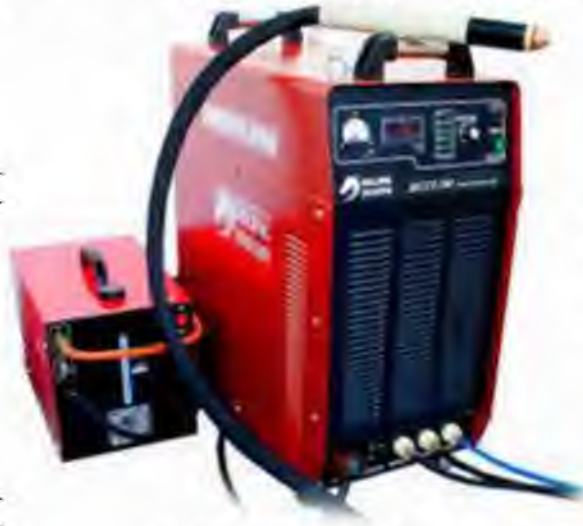
Рисунок 3.7 Установка для плазмового зварювання. Температуру шийки валу та стінки ремонтної втулки вимірювали за допомогою приладу Raytek ST 60 Pro Plus, показаного на рисунку 3.8.
