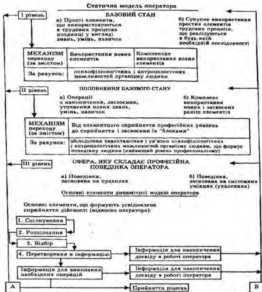
Рис. 9.10. Основні елементи моделі роботи оператора (статична і динамічна моделі) сільськогосподарської техніки
