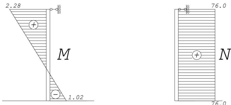
Рис. 4.9 – Епюри зусиль, які діють в колоні від снігового навантаження
