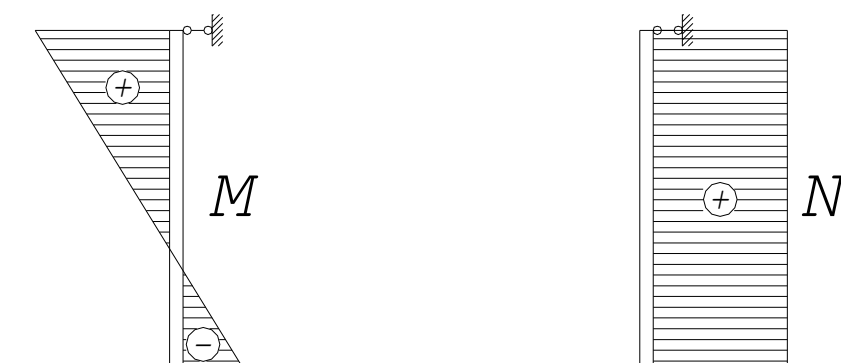
Рис. 4.10 – Епюра зусиль в колоні від ваги покрівлі
