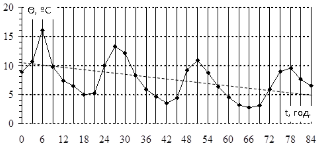
Рис. 2.8. Зміни температурних збурень у часі, що вважаються реалізаціями стаціонарного випадкового процесу із періодичними коливаннями та змінним математичним сподіванням (4 клас)
