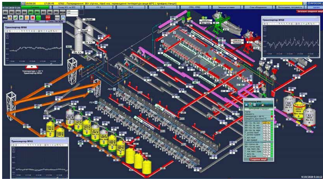
Рис. 2.1 SCADA-система(HMI) реалізована з використанням 3D-елементів
