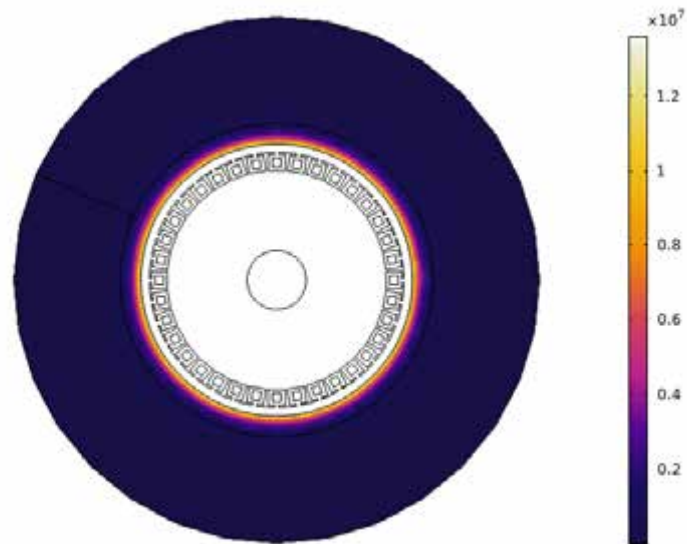
Рис.3.5.Просторове зображення об'ємної щільності електричних втрат, Вт/м 3
