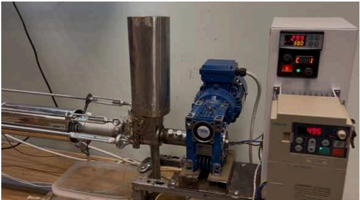
Рис.3.9. Блок керування і завантаження одношнекового електромеханічного гідролізера (без зовнішнього захисного корпусу)
