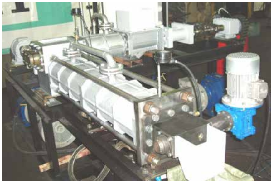
Рис 1.1. Установа високотемпературного гідролізу пухо-пір'яної сировини у тонкому шарі
