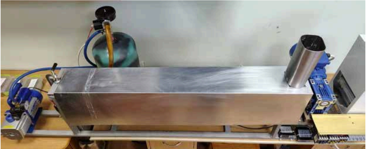
Рис.3.8. Загальний вигляд експериментального зразка одношнекового електромеханічного гідролізера
