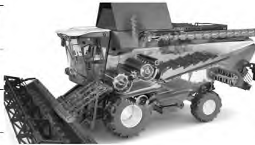
Рис. 1.6 Схема зернозбирального комбайна з поперечно-потсковим МСП і барабанним соломовідокремлювачем з одним барабаном на комбайні ACROS
