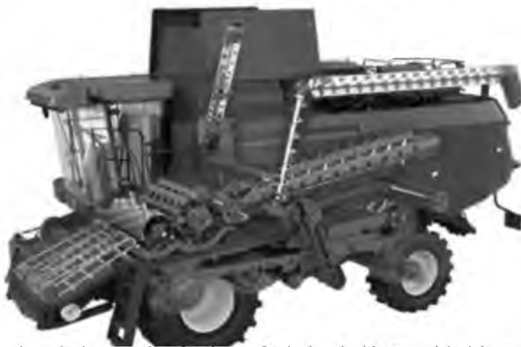
Рис. 1.4. Схема зернозбирального комбайна з поперечно погоковим МСП і роторним соломовідокремлювачем на комбайні Massey Ferguson
