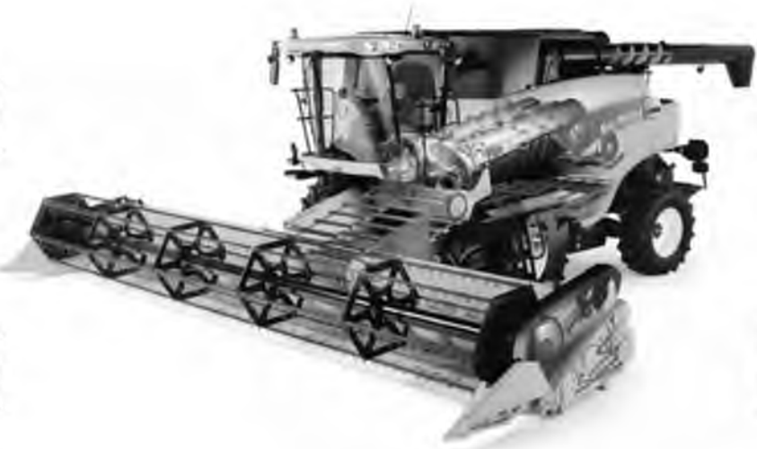
Рис.1.5 Схема роторного зернозбирального комбайна з двома поєздовжніми роторами і аксіальною подачею на комбайні New Holland
