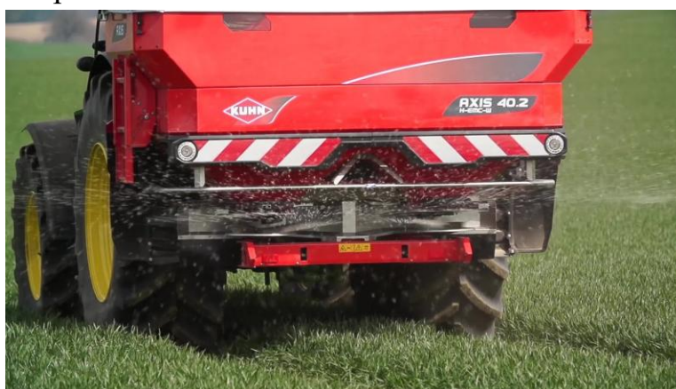
Рис. 1. Начіпний розкидач гранульованих мінеральних добрив фірми KUHN
