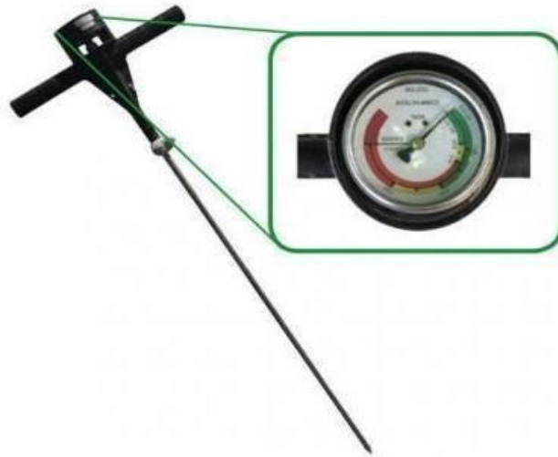
Рис. 1 – Загальний вигляд ручного пенетрометра з механічною шкалою
