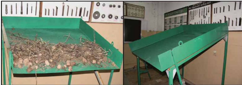
Рис. 2. Ємність для попереднього розміщення і подачі вороху на поверхню органу виносної сепарації
