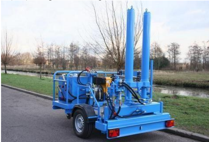
Рис. 3 - Гідравлічний пенетрометр GeoMil 200kN (20т)
