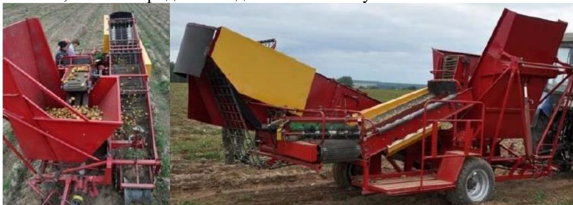
Рис. 2. Однорядний картоплезбиральний комбайн ККУ-1
