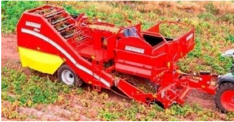
Рис. 3. Однорядний картоплезбиральний комбайн Grimme SE 75
