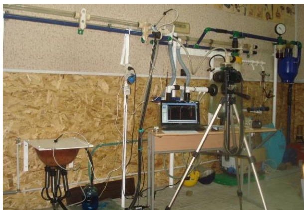
Рис. 1. Загальний вид експериментального стенду доїльної установки із доїльним апаратом одночасної дії доїльної установки із доїльним апаратом одночасної дії при підключенні його до верхнього молокопроводу
