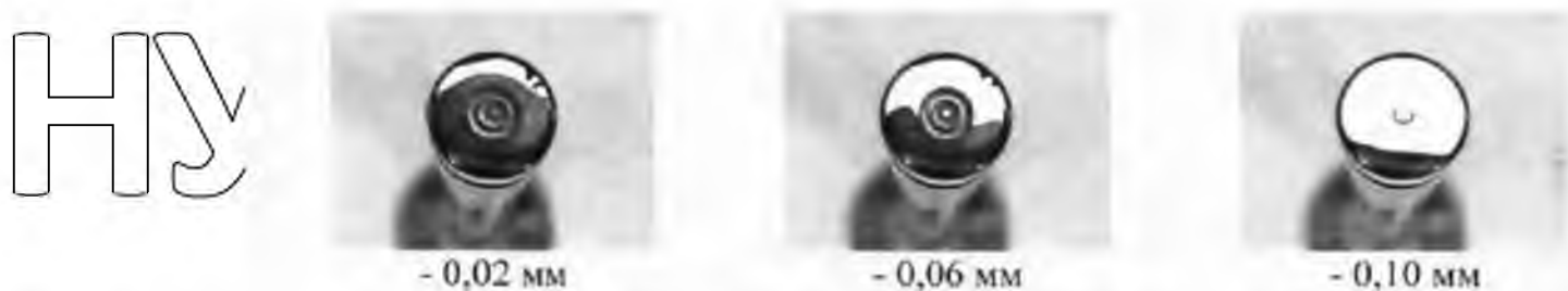
Рис. 3.4 Відбитки зашліфованої поверхні торця клапана
