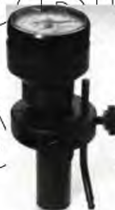
Рис. 3.6 Індикаторний пристрій для перевірки биття сидла клапана
