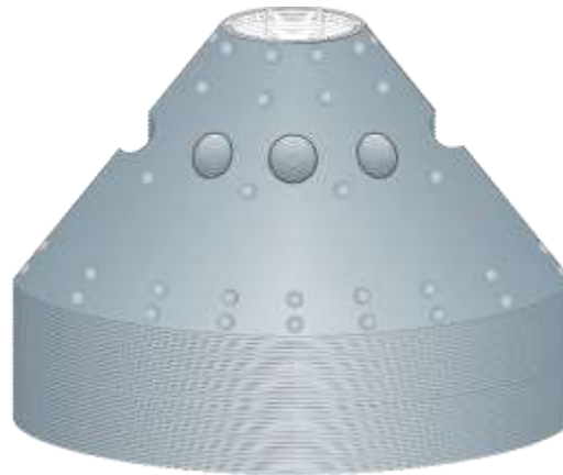
Рис. 4.19 Тарілковий пакет з розподільними отворами й дистанціюючими наклепками.
