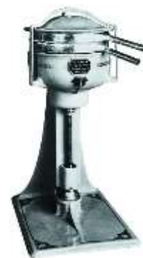
Рис. 3.5 Один з найперших сепараторів, Альфа А 1, що випускався з 1882 г.
