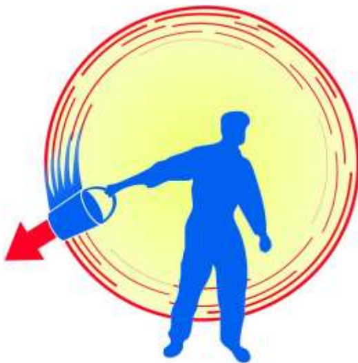
Рис. 4.11 В обертій посудині виникає відцентрова сила
