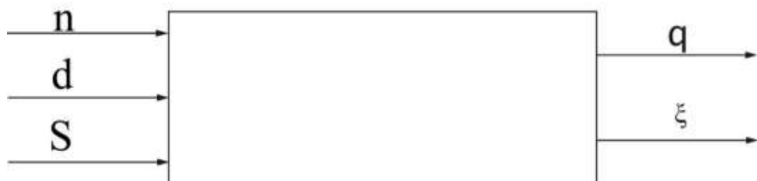
Рис 4.0. Кібернетична схема процесу сепарації молока.
