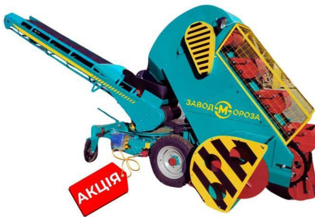
Рисунок 1.2 – Самохідний ковшовий шнековий навантажувач Р6 – КШП – 6
