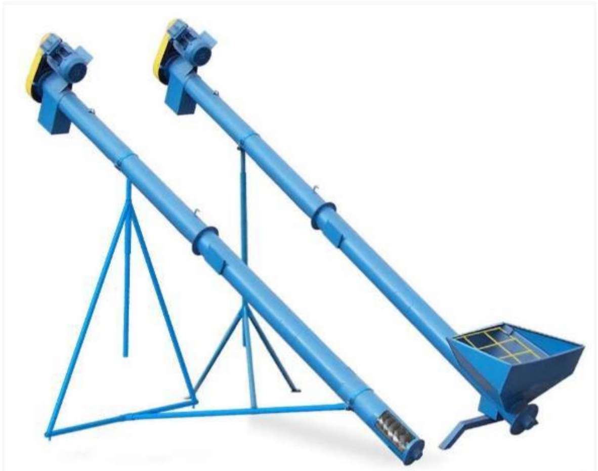
Рисунок 1.5 – Шнековий навантажувач ПШП-4А (ПШ-4)
