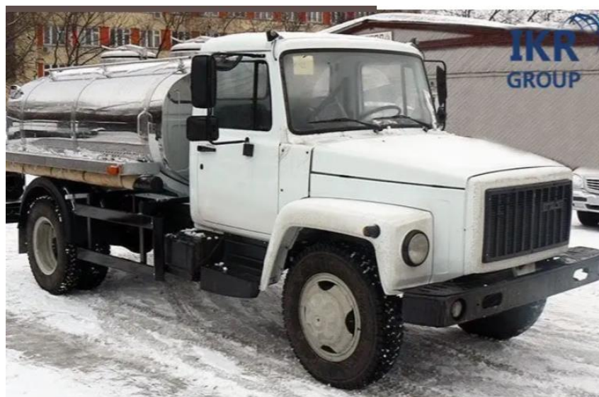
Рисунок 1.4 – Молоковоз із цистерною для молока 1000 літрів, на базі Газель Next
