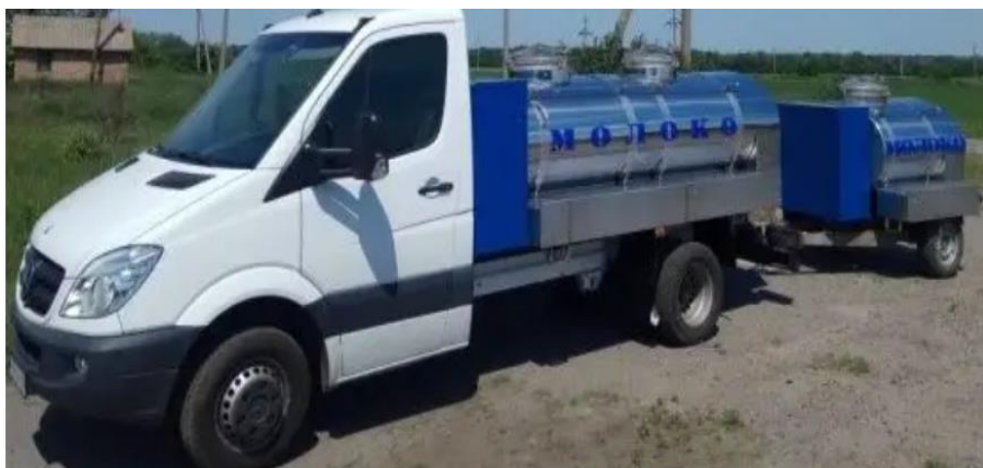
Рисунок 1.4 – Молоковоз із цистерною для молока 1000 літрів, на базі Газель Next
