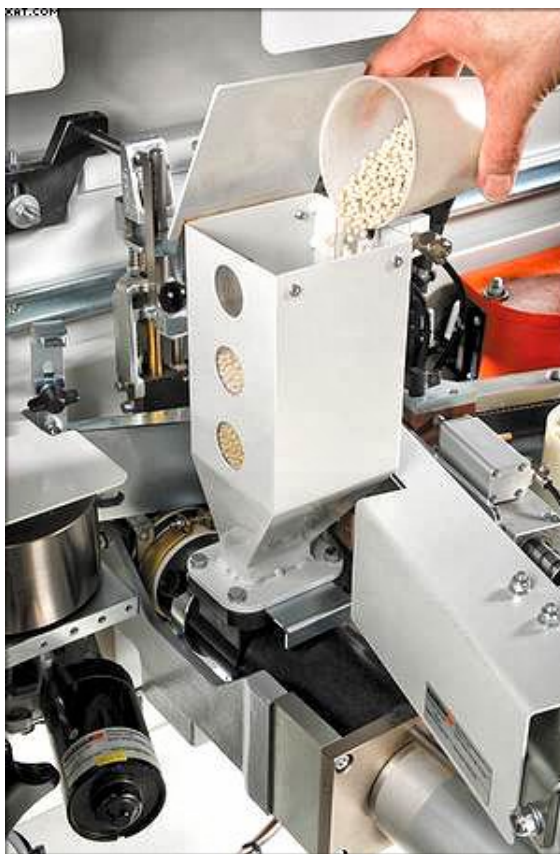
Рис. 1.10. Клеєва станція Glu-Jet, яка встановлена на кромкувальному обладнанні Holz-Her. [22]
