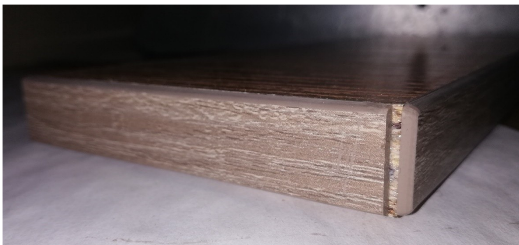
Рис. 3.7. Результат випробування зразка з EVA кромкування в камері з зміною вологістю при температурі 80°C
