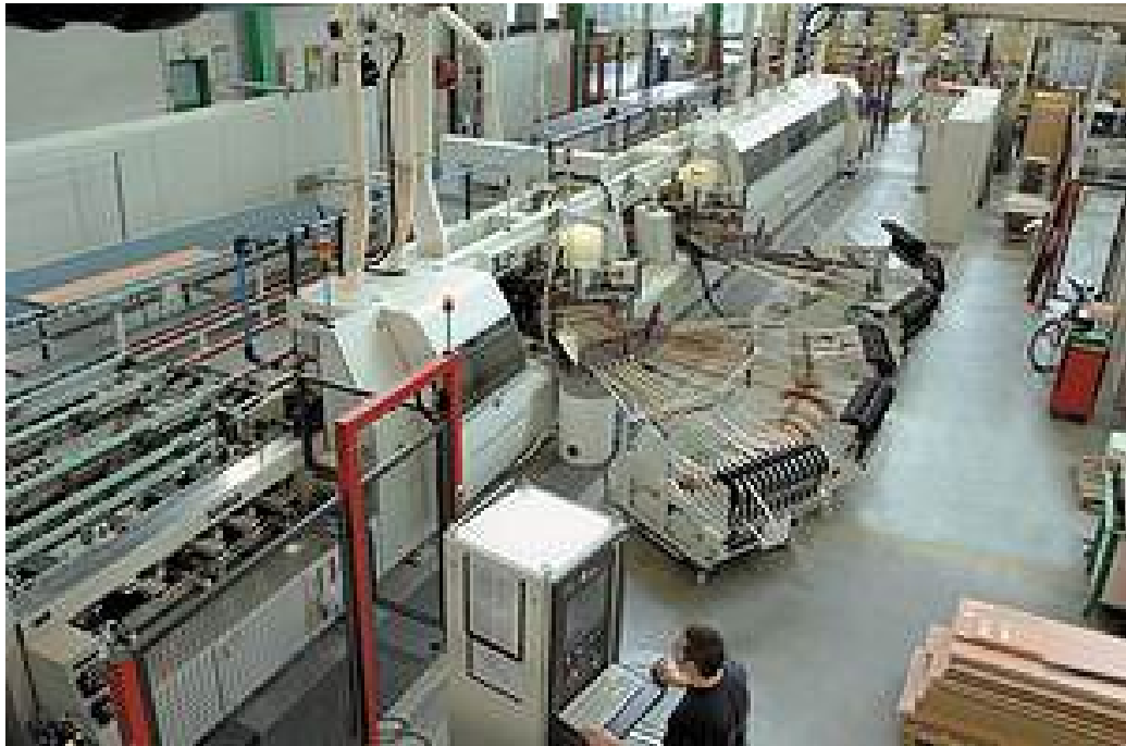
Рис. 1.6. Верстат IMA Combima для прямолінійного нанесення кромки з декількома клеєвими вузлами і магазином для кромки на 72 рулона [18]
