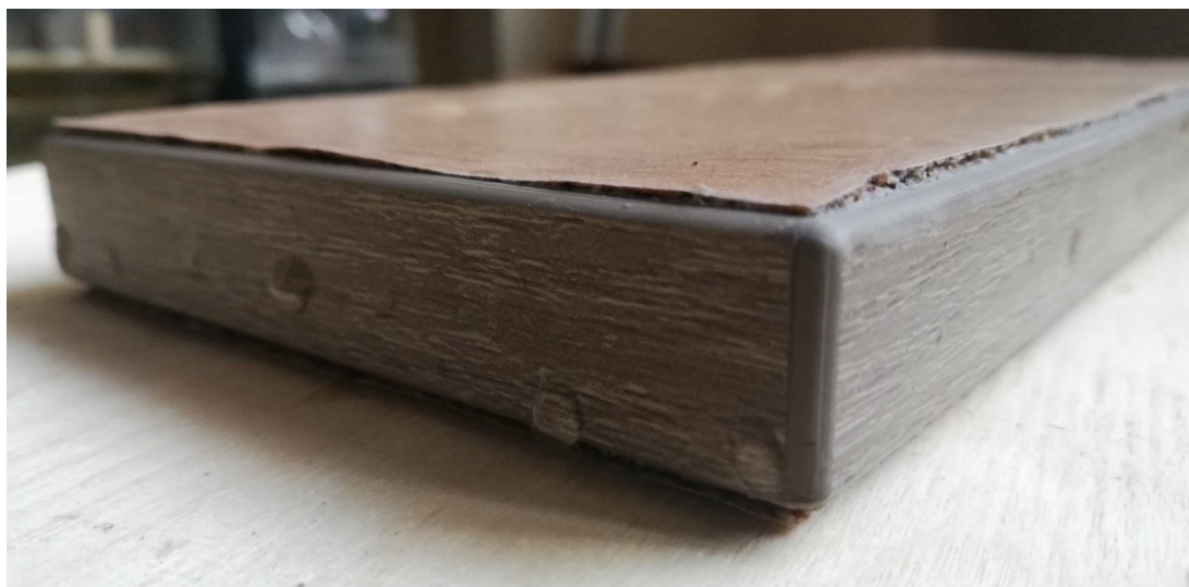
Рис. 3.4. Розбухання зразка ДСП з EVA поклейкою через годину після початку експерименту
