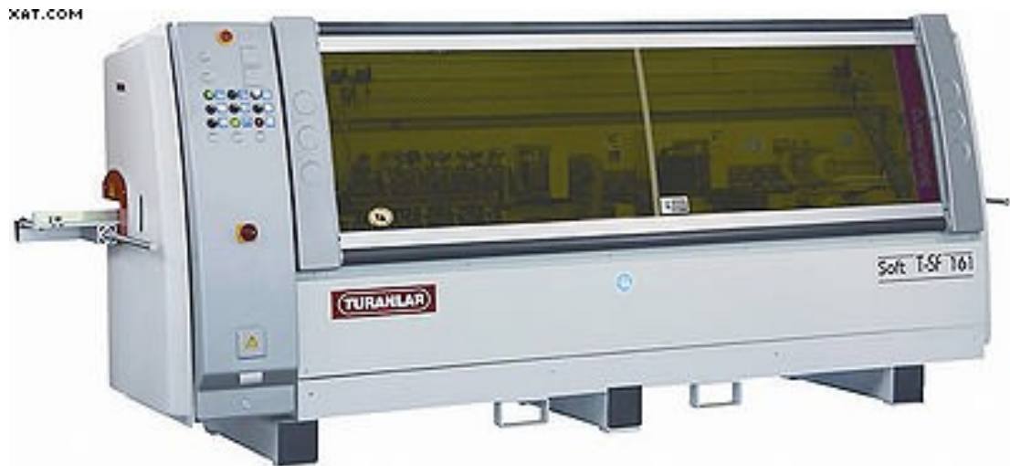
Рис. 4.10 Верстат для облицювання кромки способом софтформінгу, не оснащений агрегатом для фрезерування профілю кромки [49]
