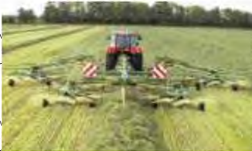
Рис. 1.2 – Валкоутворювач Swardo 1400 (фірми KRONE)
