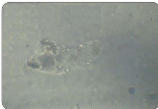
Рисунок 3.7 – Неоднорідність ізоляції визвана неповним розплавленням гранул поліетилену
