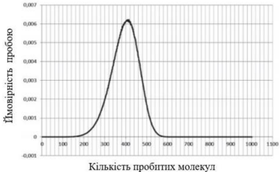
Рисунок 3.11 – Графік ймовірності пробою ізоляції ділянки на кількість проколотих молекул СН
