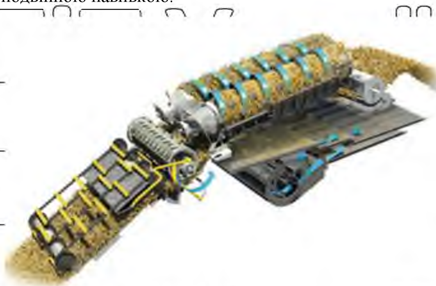
Рис. 2.3. Схема молотарки зернозбиральних комбайнів серії CR
