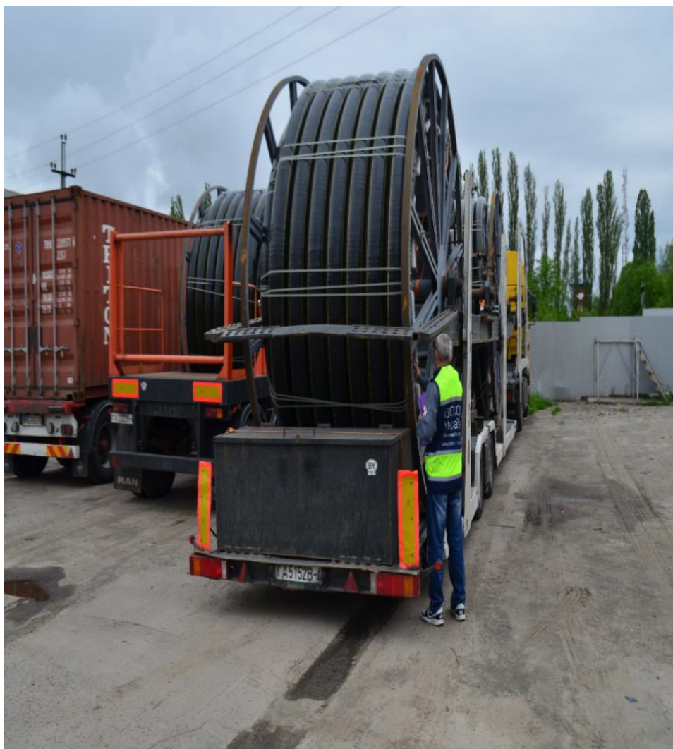
Рис. 4.1. Зовнішній вигляд попередньоізольованої труби AustroISOL
