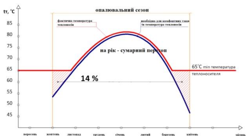
Рис. 4.11. Графік зниження перетопів за рахунок установки регулятора перепаду температури
