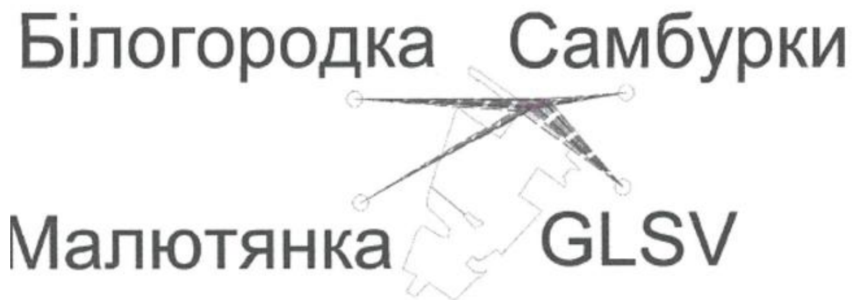
Рисунок 2. Схема прив'язки місцезнаходження межових знаків земельної ділянки з кадастровим номером 3222481600:02:001:5160
