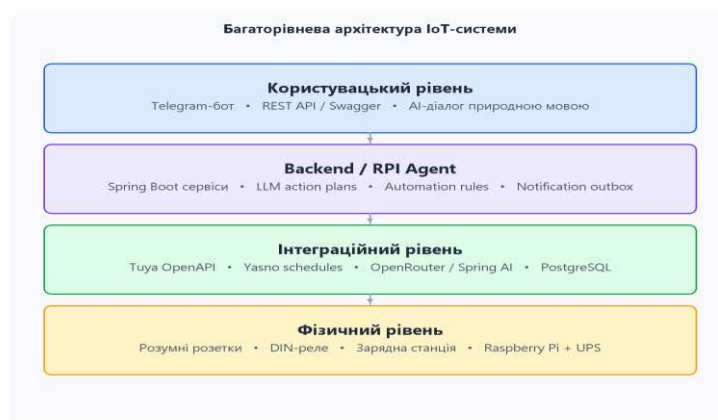
Рисунок 1.1 – Багаторівнева архітектура IoT-системи
