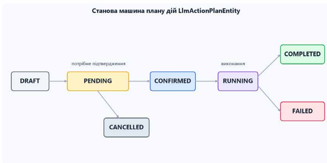
Рисунок 4.3 – Станова машина плану дій LlmActionPlanEntity
