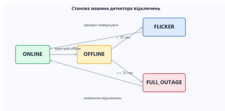
Рисунок 2.7 – Станова машина детектора відключень (FLICKER vs FULL_OUTAGE)
