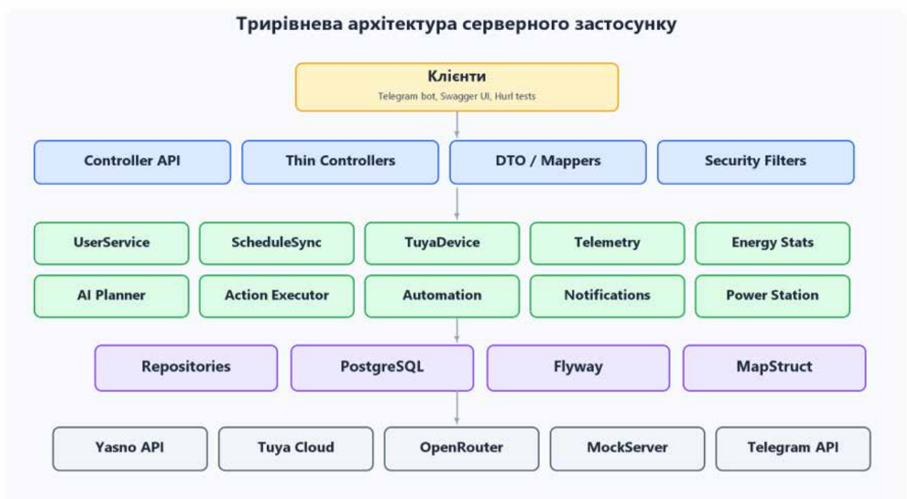
Рисунок 2.1 – Трирівнева архітектура серверного застосунку
