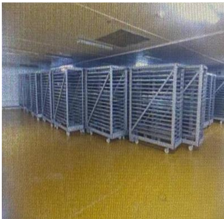
Рис. 11. Інкубаційні візки в приміщенні для сортування, овоскопування та укладання яєць в інкубаційні лотки
