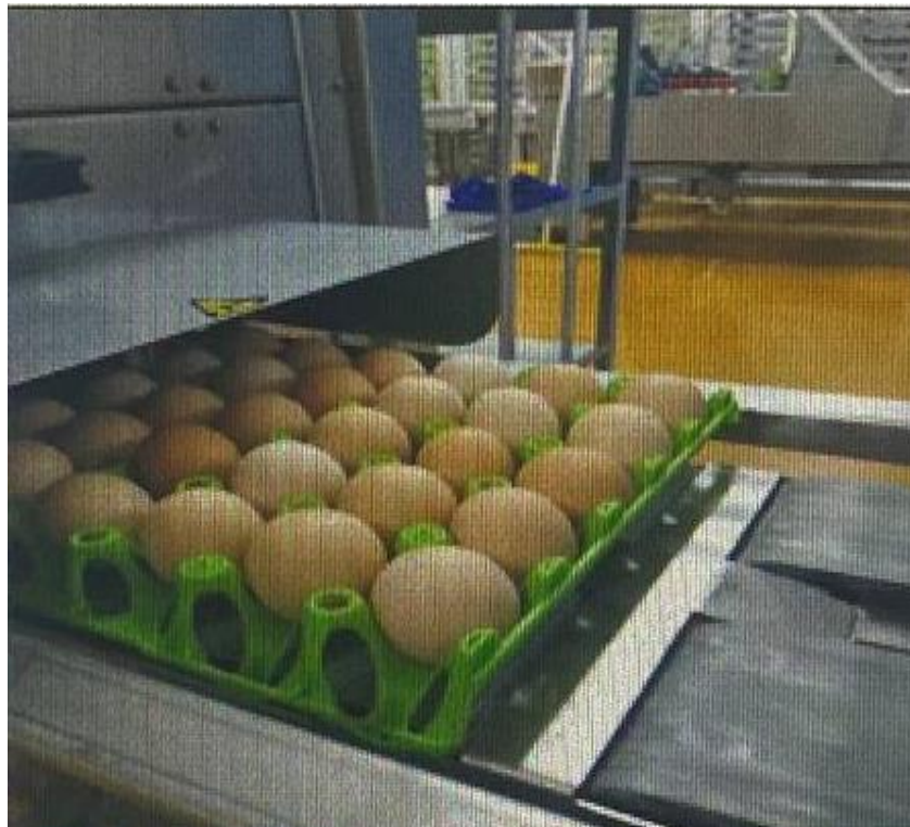
Рис. 15. Переміщення яєць на перекладач
