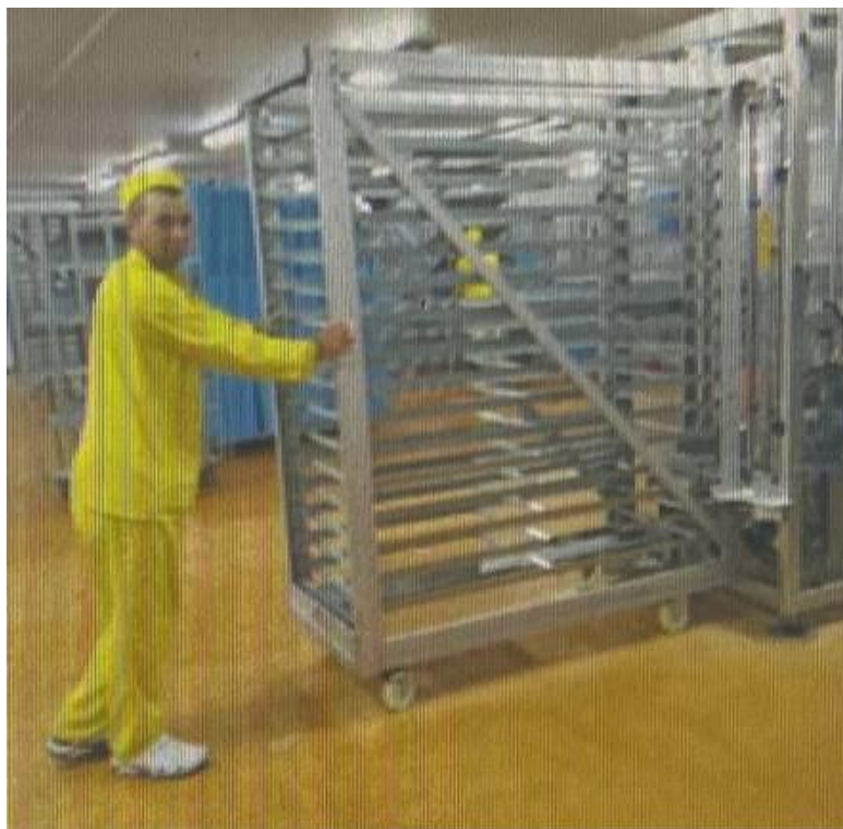
Рис. 12. Інкубаційний візок на пристрої загрузки
