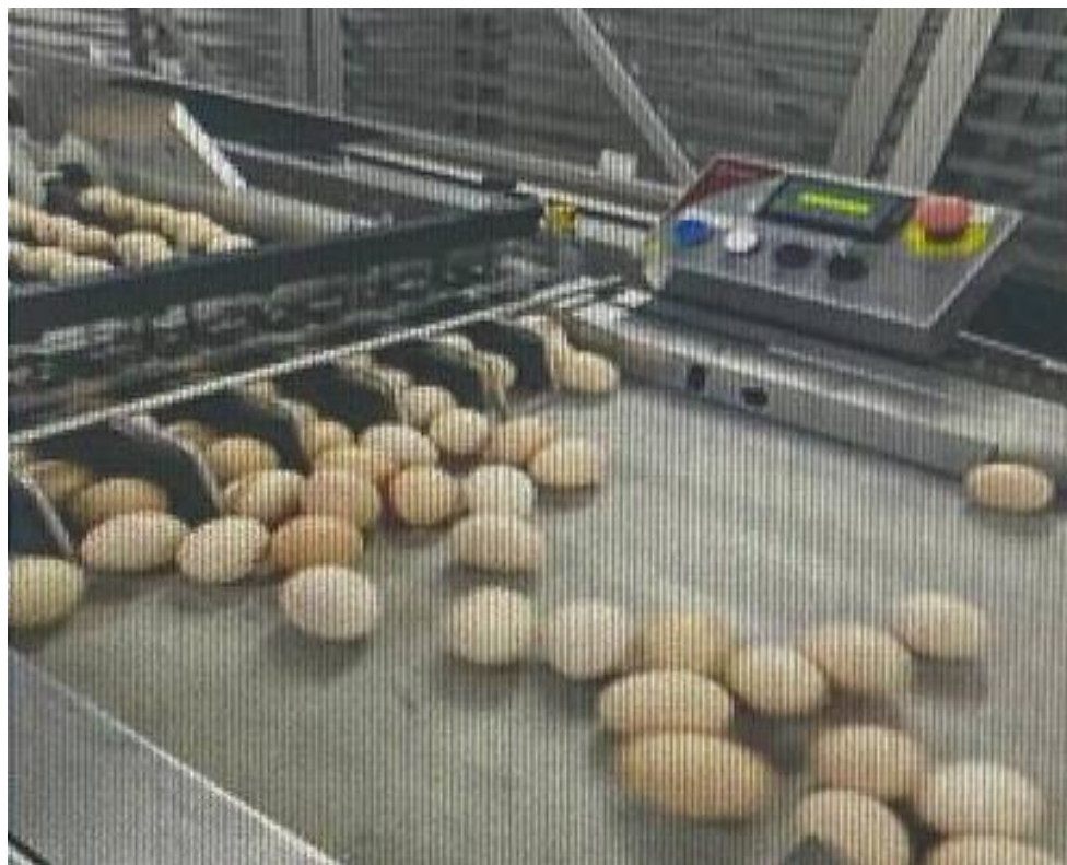
Рис. 18. Яйця на пристрої змінення порядку подачі яєць
