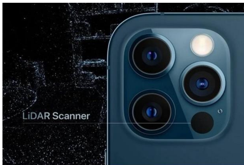
Рисунок 2.3.1 – Розташування LiDAR–сканера на панелі смартфона URL: https://mezhamedia/articles/yak-vykorystovuvaty-lidar-na-iphone-ta-ipad/ .
