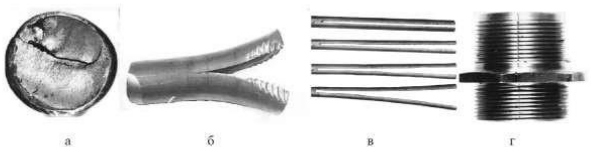
Рисунок 2.8. Дефекти каліброваних металевих виробів: а - розкриття торця бруска при виході з матриці; б - тріщина на кінці заготовки згодом холодна деформація; в - деформація форми заготовки при фрезеруванні поздовжньої канавки; д - тріщина на поверхні деталі після різання
