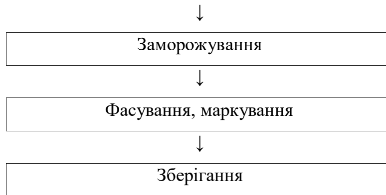
Рисунок 4.1 Технологічна схема виробництва фаршу з коропа з додаванням соєвих ізолятів
