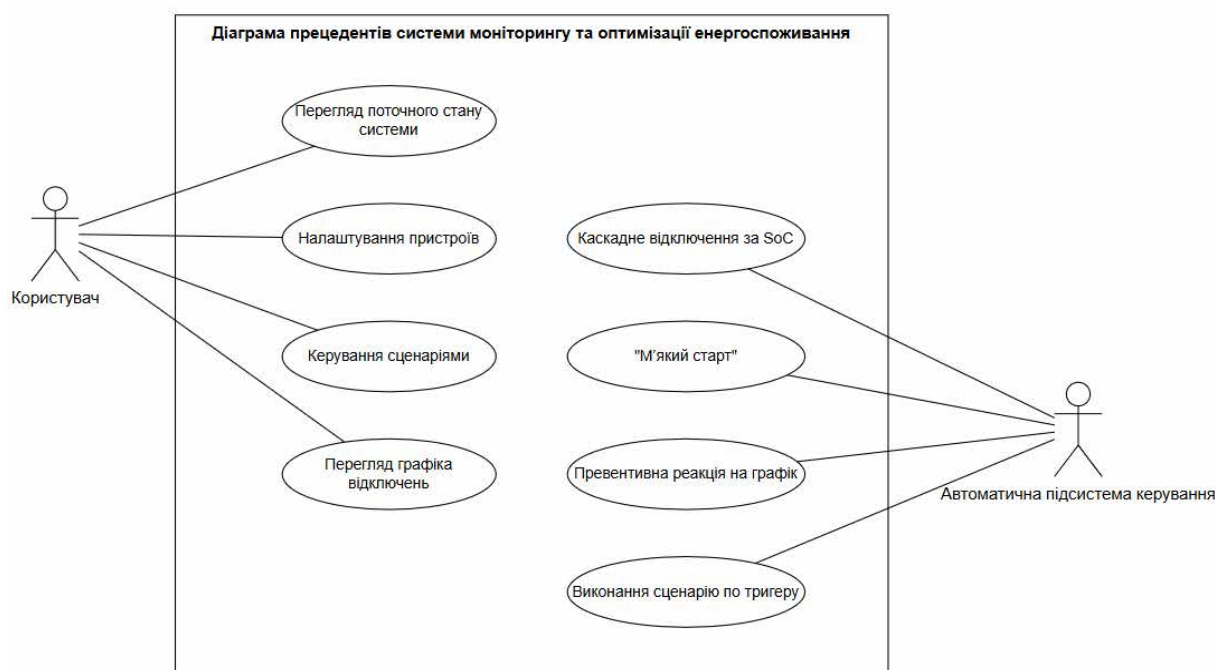
Рис. 1.1 – Діаграма прецедентів системи моніторингу та оптимізації енергоспоживання
