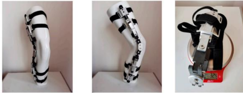
Рис.2.5 Колінний ортез, надітий на модель протеза людської ноги
