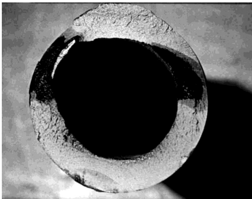
Рис. 4.1 – Руйнування осі балки в процесі експлуатації
