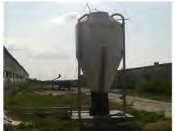
Змішувач сипучих кормів ЗСК-Ф-10А та зовнішній кормовий бункер
