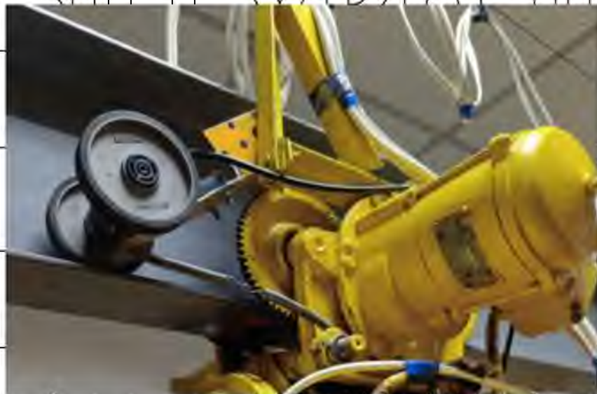
Рис. 3.3. Закріплені енкодер для вимірювання швидкості електрододу
