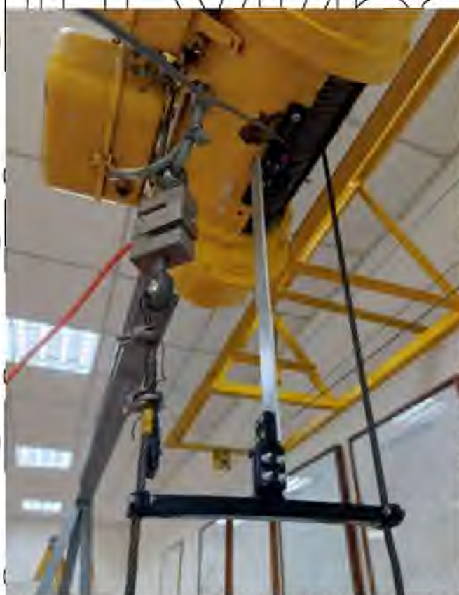
Рис. 3.5. Закріплений датчик для вимірювання коливань вантажу
