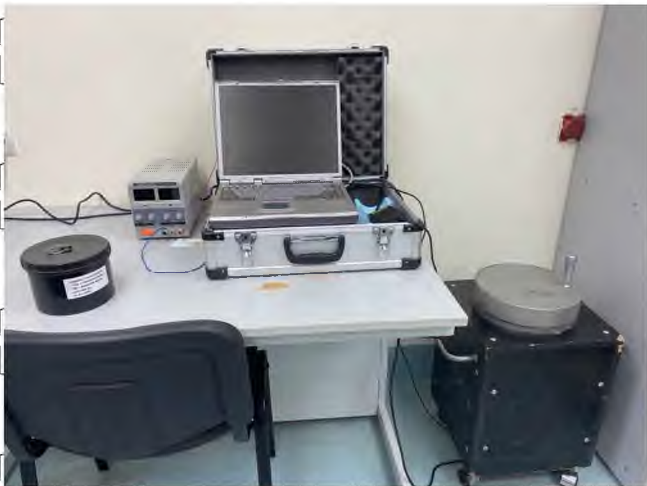
Рис 2.3 – Сцинтиляційний \gamma -спектрометр SEF-05 (Україна)
