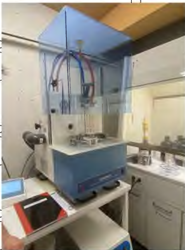
Рис. 2.7 – Зовнішній вигляд системи мікрохвильового травлення з однокамерною реакційною камерою UltraWave ECR від Milestone
