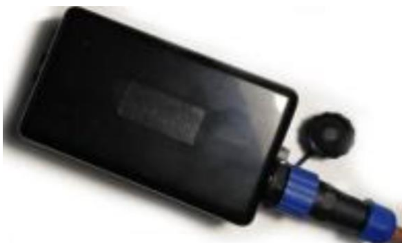
Рис. 3.10. Блок керування трекерами CST1000W
