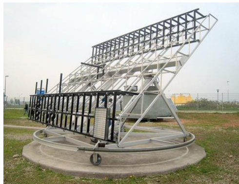
Рис. 2.5. Конструкція трекера типу AADAT
