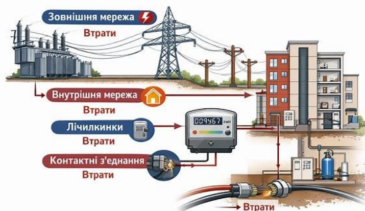
Рис. 2.3. – Схема джерел втрат електричної енергії у мережі 10 кВ
