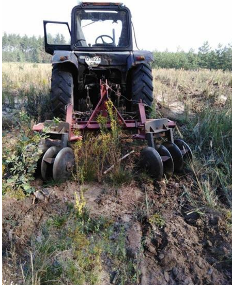
Рис.2.1. Культиватор лісовий дисковий КЛД-1,8 в агрегуванні з трактором загального призначення МТЗ-82 під час проведення експериментальних досліджень
