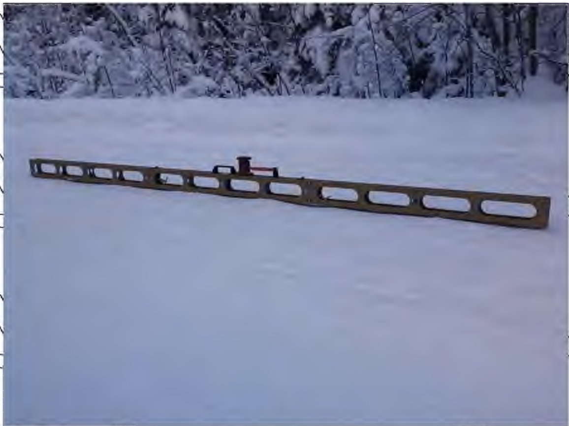
Рис. 4.1 Дорожня універсальна складна триметрова рейка «РДУ – Кондор»
