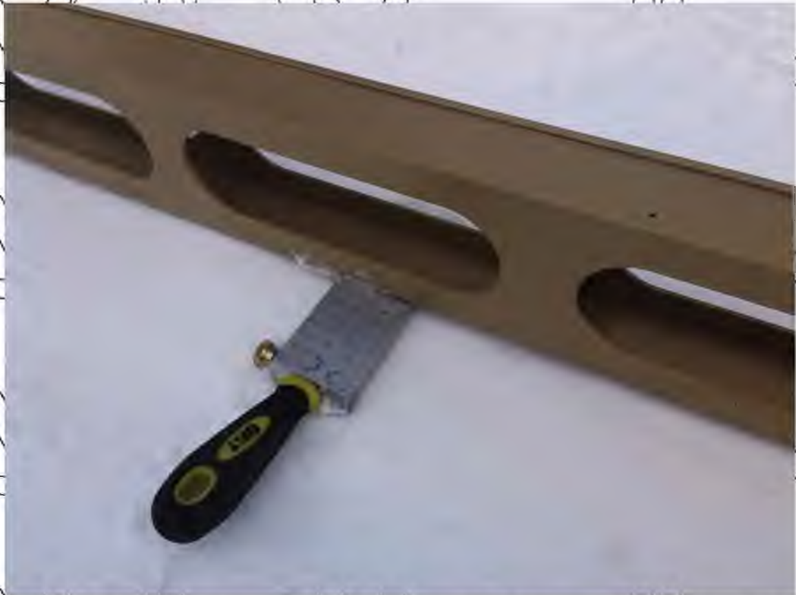
Рис. 4.2 Вимірювання нерівності покриття за допомогою мірного клина
