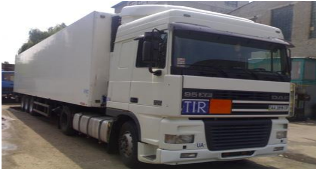
Рисунок 1.7 – Тягач DAF та ізотермічний напівпричіп.
