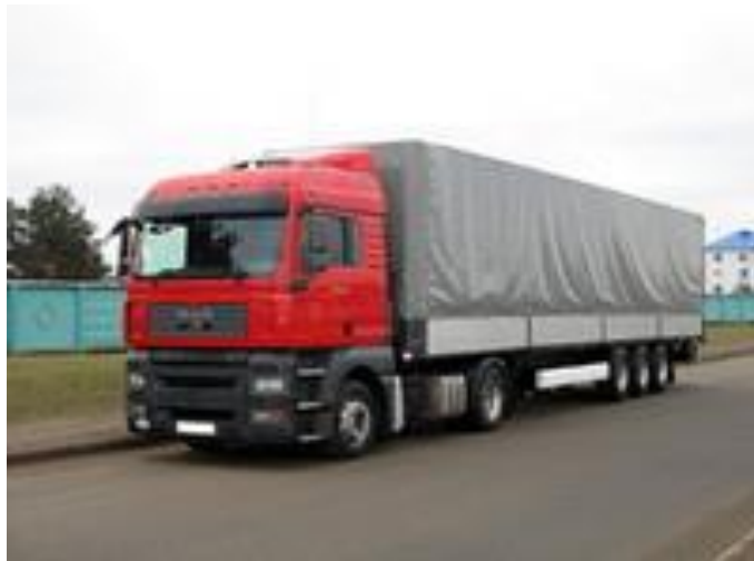
Рисунок 1.3 – ADR-тент, напівпричіп для перевезення небезпечних вантажів
