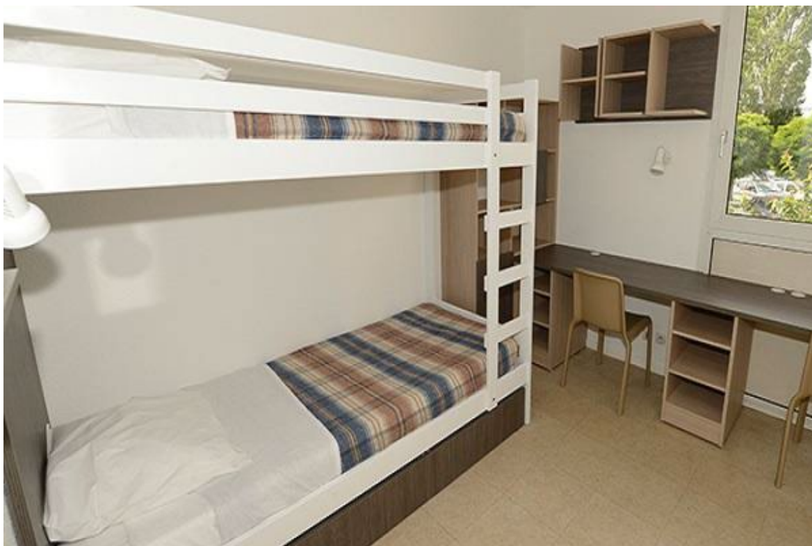
Рис. 1.13. Корпусні меблі з ДСП ламінованої, а конструкційні з фарбованого масиву [9]
