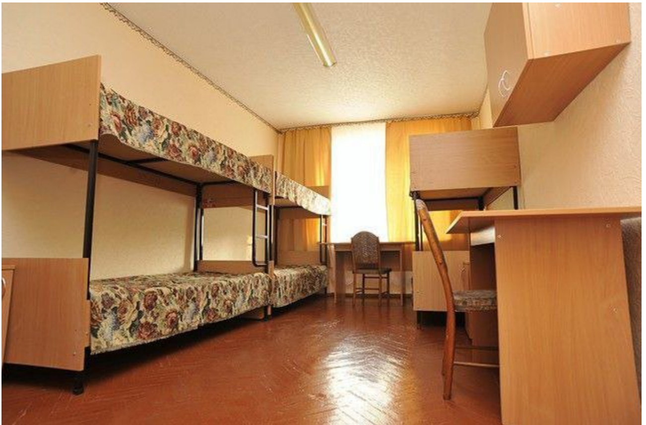
Рис. 1.1. Каркаси з профільної труби. Корпусні меблі та елементи ліжок з ламінованої ДСП
