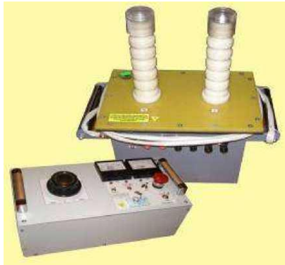
Рис. 3.4. Високовольтне випробувальне встановлення УВУ-50/70Л-03
