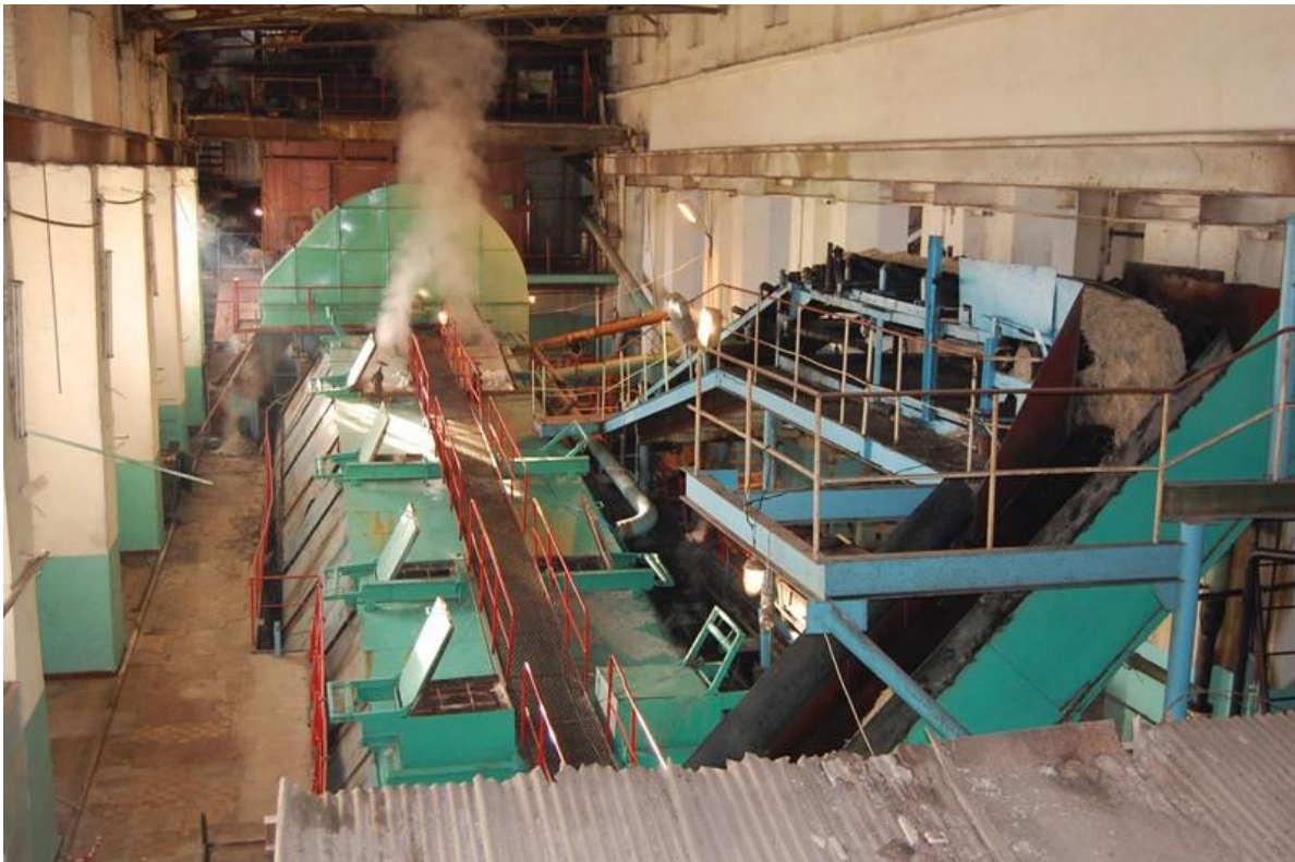
Рис.1.2. Похилий дифузійний апарат типу ДС-8 на Іллінецькому заводі
