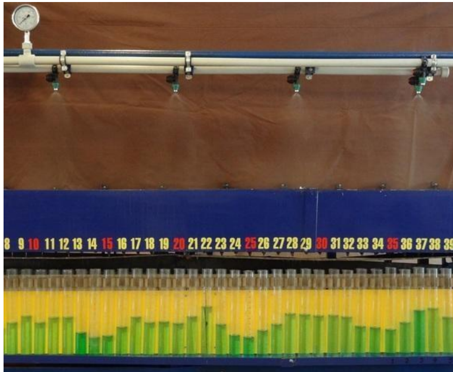
Рис. 4.7. Фото гідравлічного стенду під час дослідження рівномірності розподілу рідини по довжині штанги
