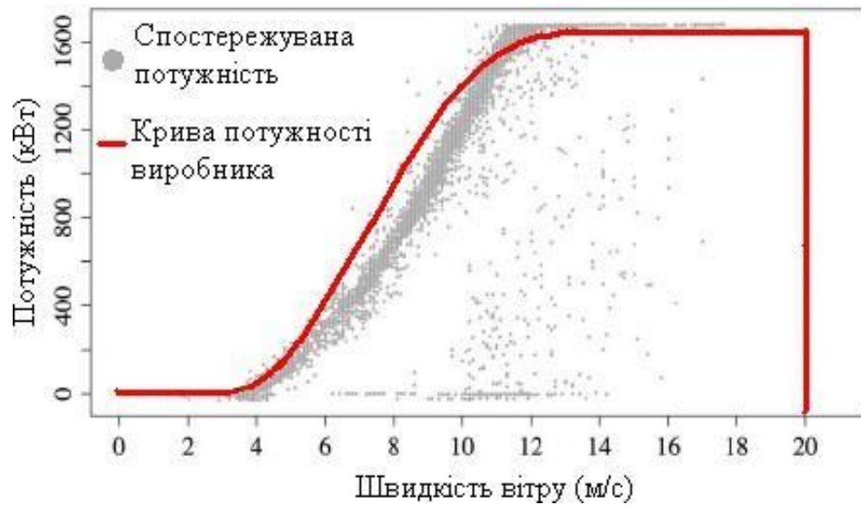
Рис.1.3. Крива потужності великої ВЕУ P=1650 кВт, V_n=13 м/с
