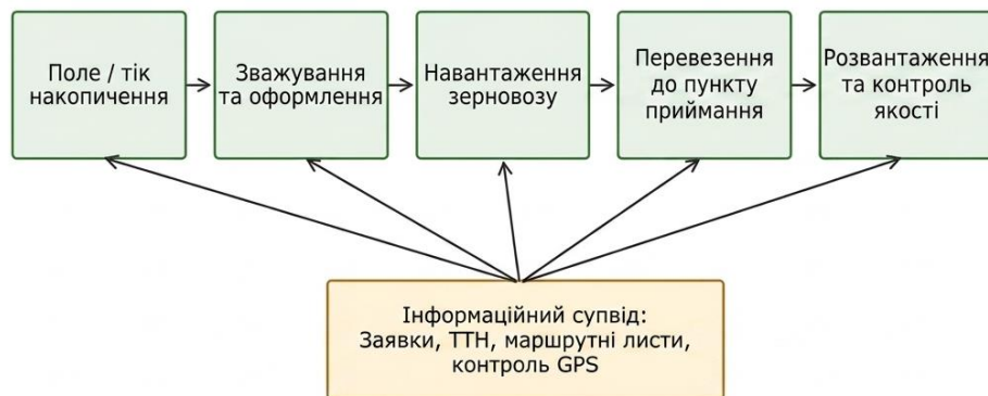
Рис. А.2. Схема транспортно-технологічного процесу перевезення зернової продукції
