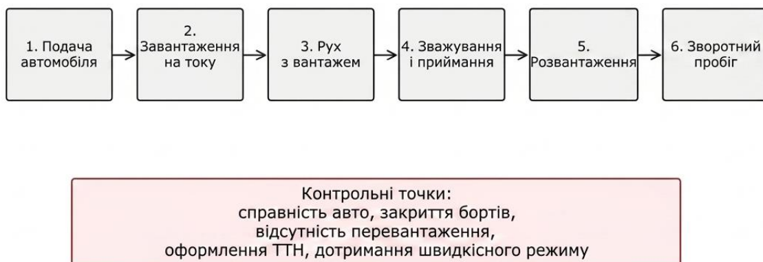
Рис. І.1. Операційна схема одного обороту автомобіля
