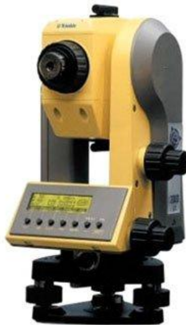
Рис. 3.3.4 Тахеометр Trimble 3305 DR
