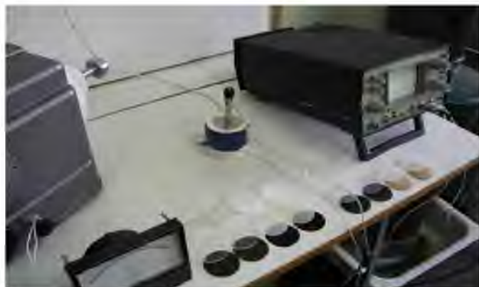
Рис.3.4. Зовнішній вигляд установки для дослідження інтенсивності іонізаційних процесів у зерновій масі під дією електричного поля високої напруженості змінного струму
