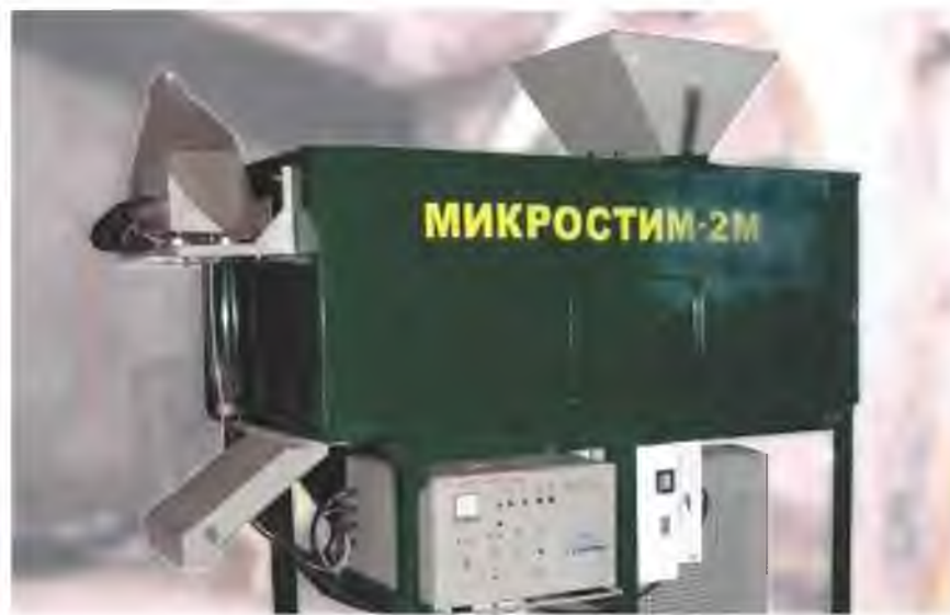
Рис. 1.2. Установка для обробки насіння мікрохвильовим полем
