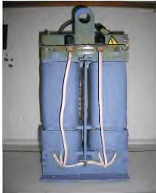
Рис. 4.7. Високовольтний трансформатор сухий ОСВ – 1,5 220/15000
