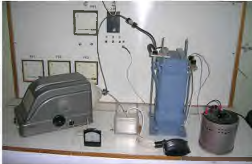
Рис. 3.20. Зовнішній вигляд установки для визначення концентрації озону у зерновій суміші
