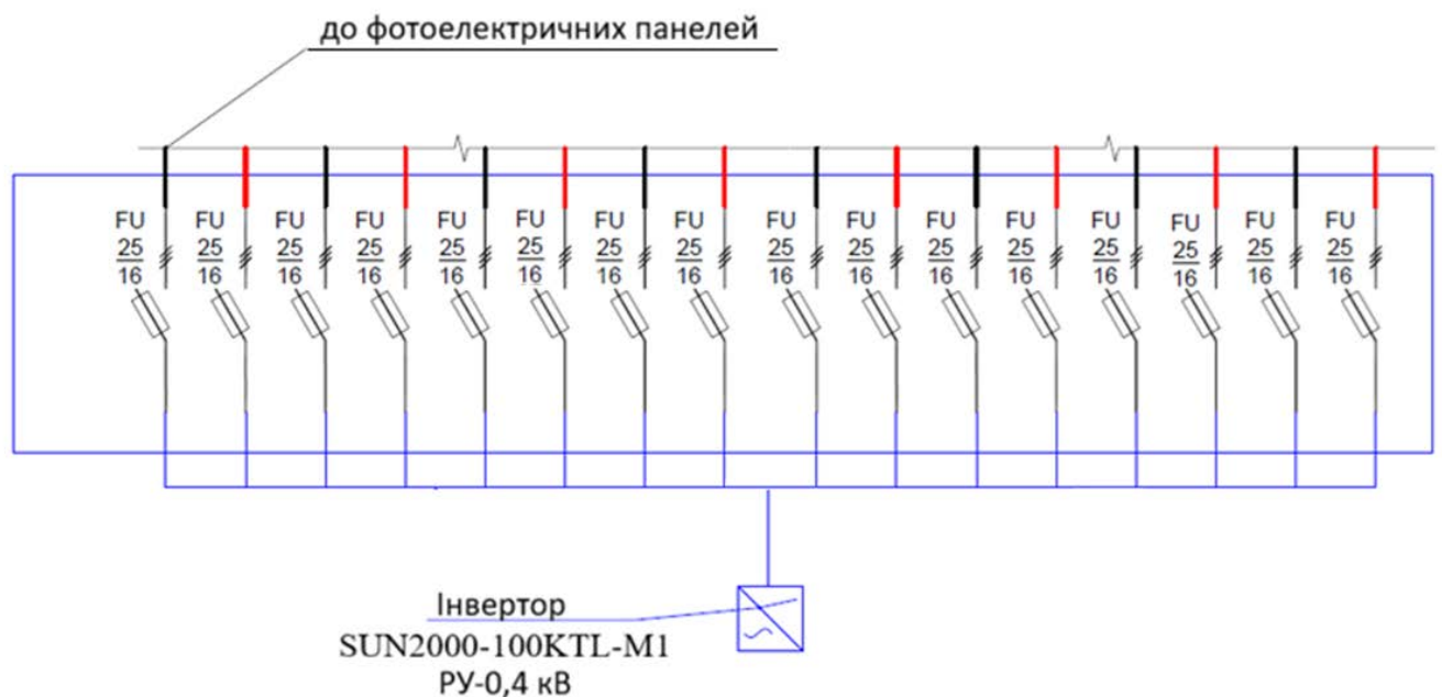
Рис. 3.3. Однолінійна електрична схема захисту фотомодулів по DC.
