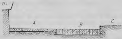
Рис. 27. Профиль по длинѣ стойла.
