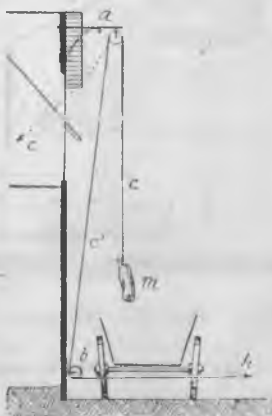
Рис. 185. Подъемъ хлѣба посредствомъ блоковъ и веревки.
