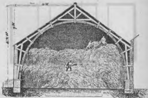
Рис. 214. Поперечный разрѣзъ большой риги.
