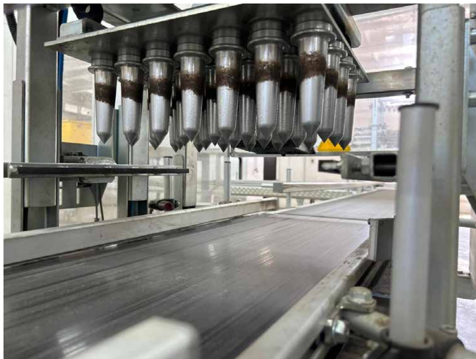
Рис. 2.4. Лункоутворювач для пересаджування ялиці білої ( Abies alba . Mill.)
