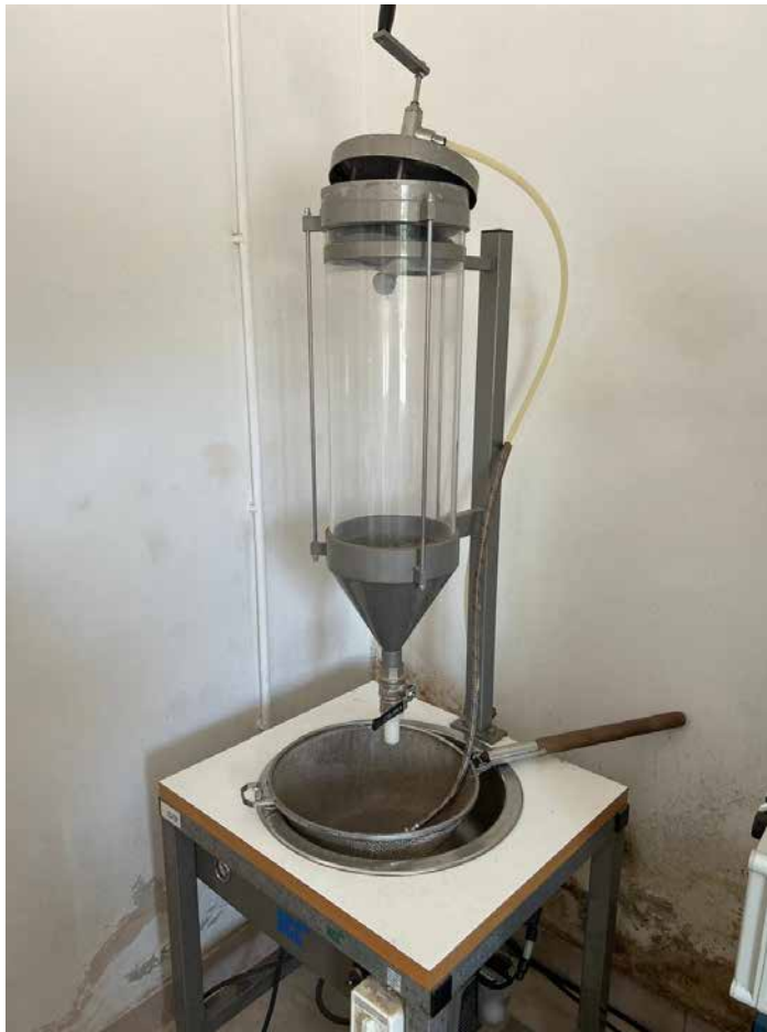
Рис. 3.16. Рідинний вакуумний сепаратор (PREVAK)
