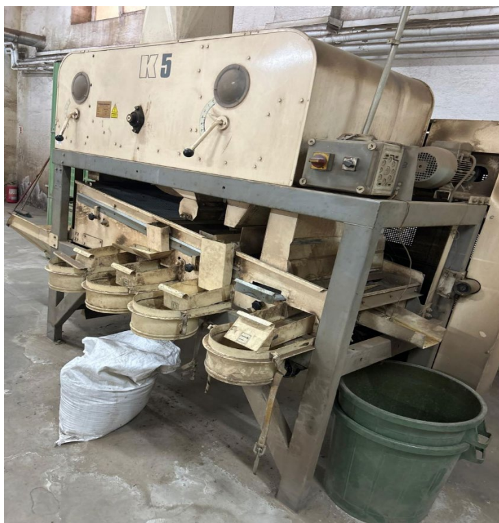
Рис. 3.7. Обладнання для очищення та сортування насіння
