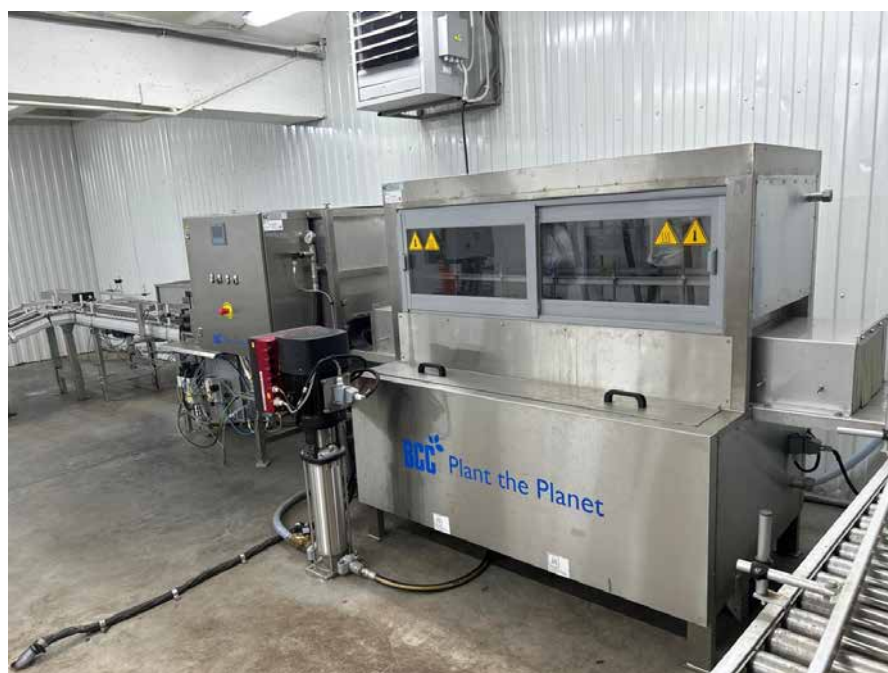
Рис. 3.13. Мийка для касет під високим тиском
