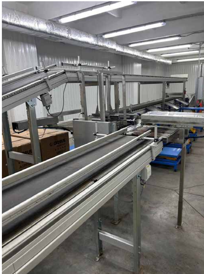
Рис. 3.10. Напівавтоматична пакувальна лінія
