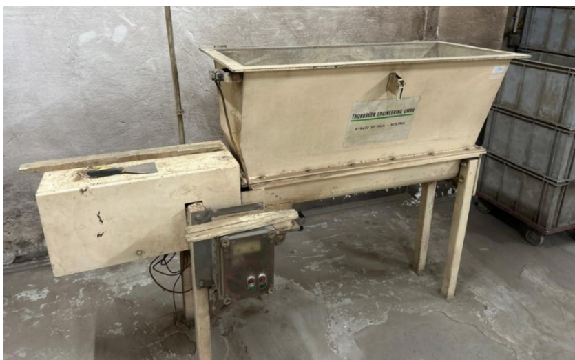
Рис. 3.6. Обладнання для обезкрилення насіння
