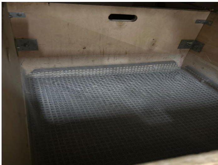
Рис. 3.3. Ящик для шишкосушарки з модернізованою поверхнею для фільтрації повітря
