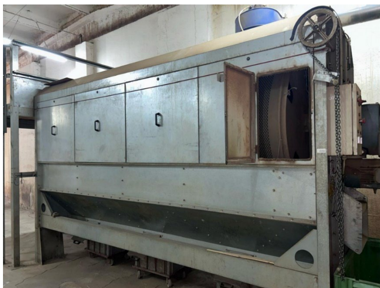
Рис. 3.4. Барабан для вилучення насіння з шишок
