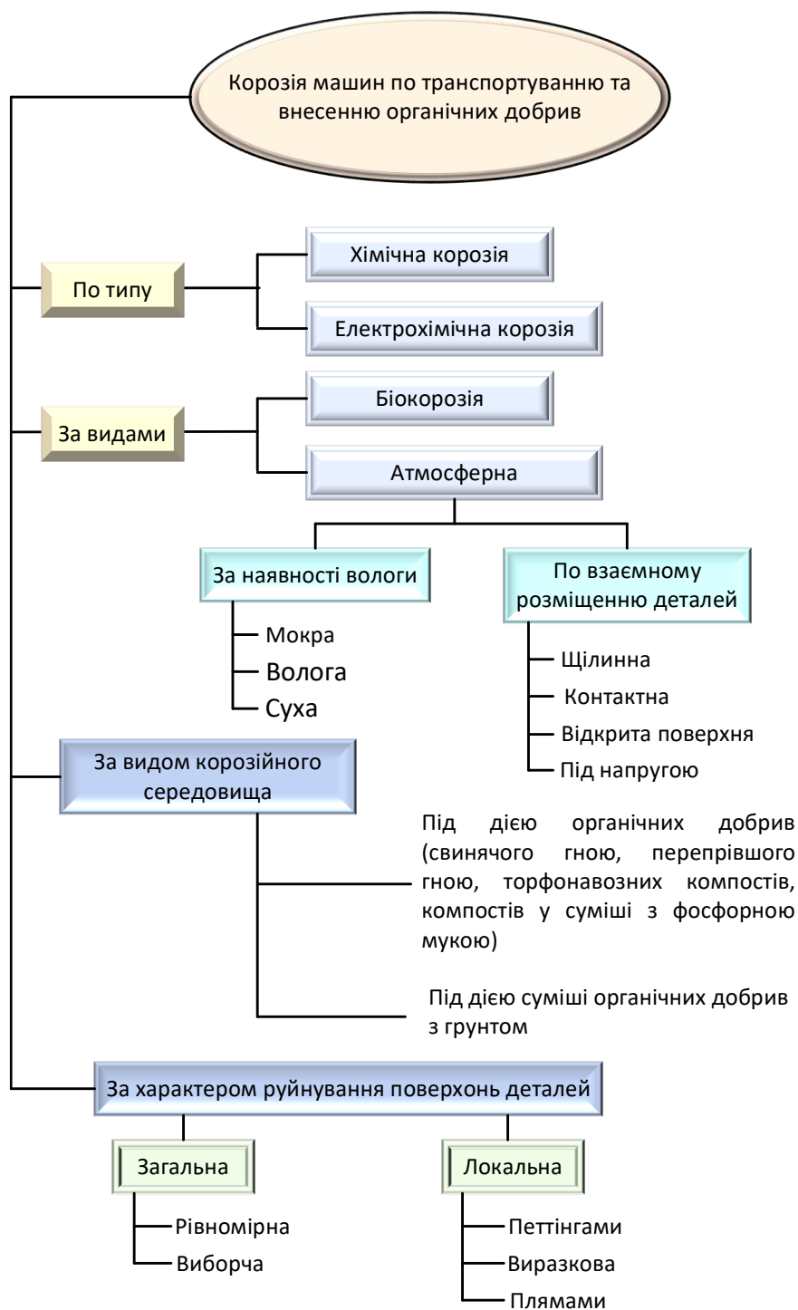
Рис. 1.5. Класифікація процесів корозії машин з транспортування та внесення органічних добрив
