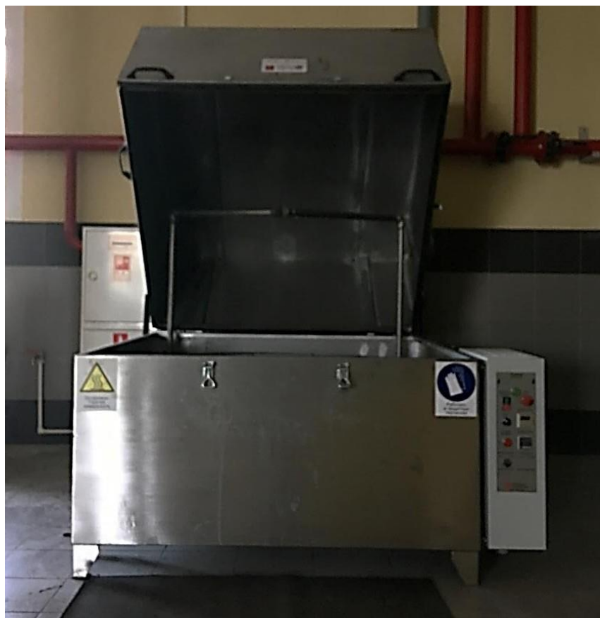
Рис. 1.12. Мийна машина для миття деталей АМ1400 АК
