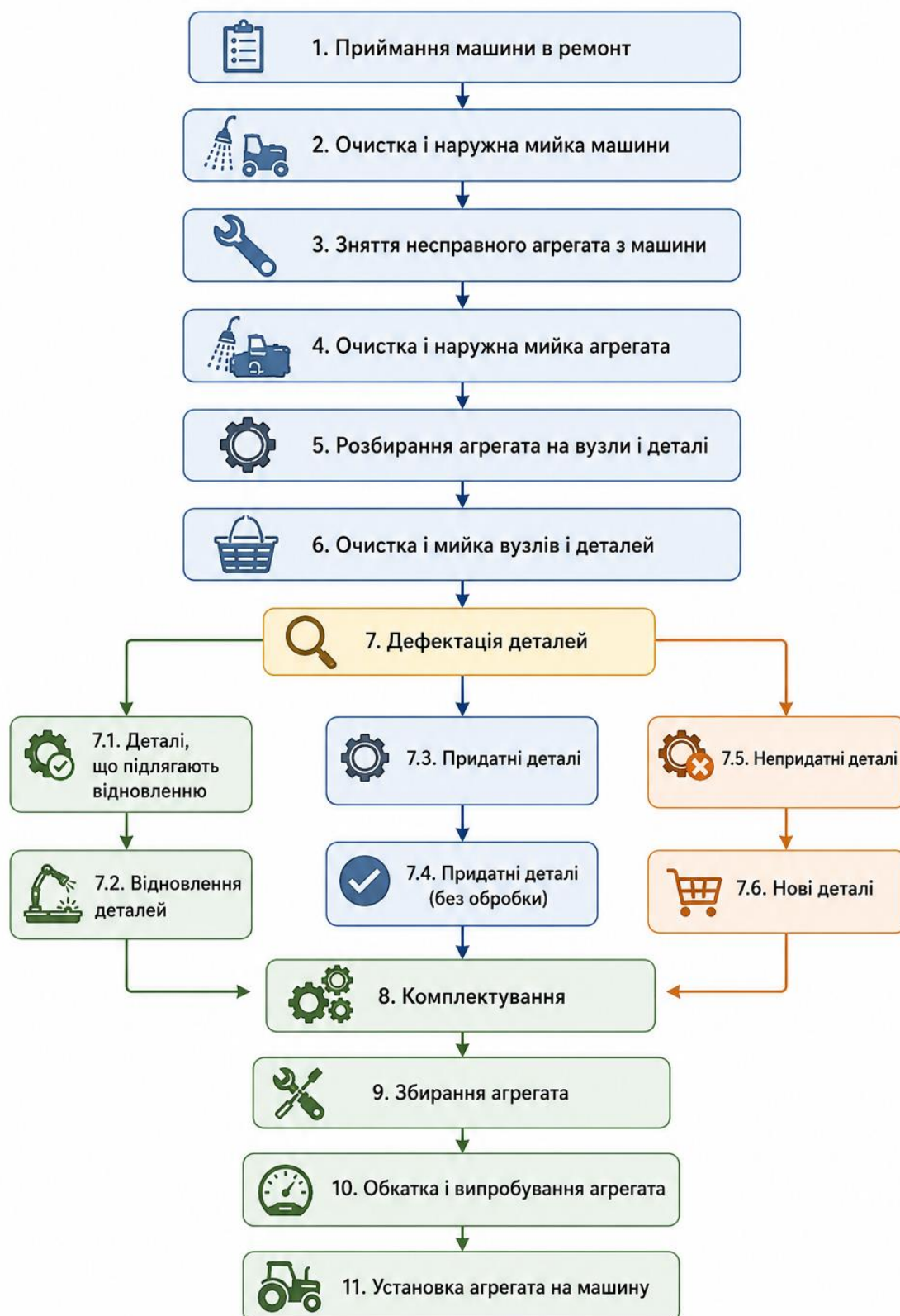
Рис. 1.9. Структурна схема технологічного процесу підготовки до ремонту та ремонту агрегатів машин
